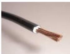
Los conductores pueden ser de dos tipos **Sólidos** (solid) e **Hilados** (stranded), los conductores sólidos están compuestos por un conductor único de un mismo material, mientras que los conductores hilados están compuestos de varios conductores trenzados. El diámetro de un conductor hilado varía al de un conductor sólido si son del mismo AWG y dependerá del número de hilos que tenga.
