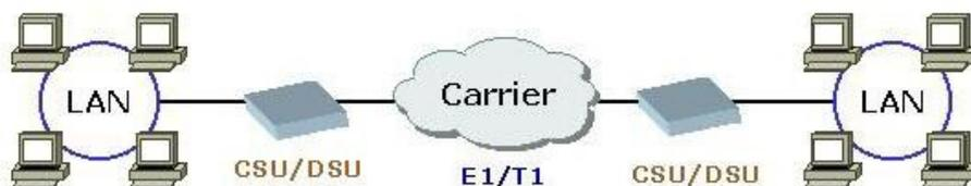
**T1:** T1 provee transmisiones de datos a velocidades de 1.544 Mbps y pueden llevar tanto voz como datos. Un T1 está dividido en 24 canales de 64 Kbps cada uno. Esto es debido a que cada circuito de voz requiere de 64 Kbps de ancho de banda, así cuando los T1 son divididos en canales de 64 Kbps, voz y datos pueden ser llevados sobre el mismo servicio T1.
