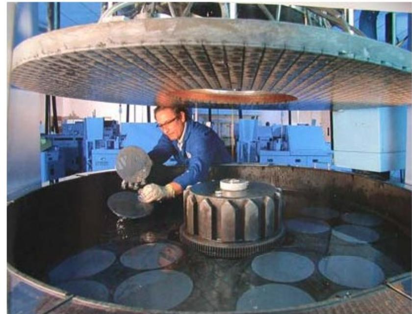
Después del esmerilado se realiza un ataque químico con una solución de ácido nítrico ( $\text{HNO}_3$ )/ácido acético ( $\text{CH}_3\text{COOH}$ ) o hidróxido de sodio ( $\text{NaOH}$ ) para eliminar grietas microscópicas derivadas del proceso de esmerilado.
