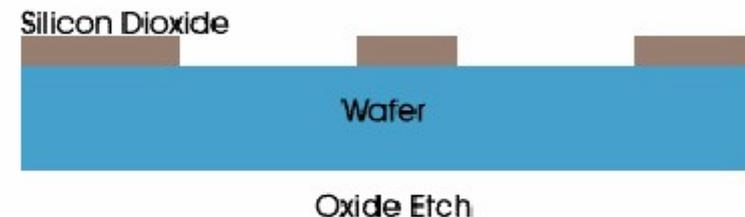
La solución con ácido fluorhídrico (HF) mezclado con fluoruro de amonio ( $\text{NH}_4\text{F}$ ), permite eliminar el dióxido de silicio sin afectar a la capa inferior de silicio o polisilicio. El ácido fosfórico ( $\text{H}_3\text{PO}_4$ ) se emplea para atacar las capas de nitruro de silicio ( $\text{Si}_3\text{N}_4$ ), el ácido nítrico ( $\text{HNO}_3$ ) se utiliza para atacar a los metales y el ácido sulfúrico ( $\text{H}_2\text{SO}_4$ ) se utiliza para eliminar la fotoresina.
