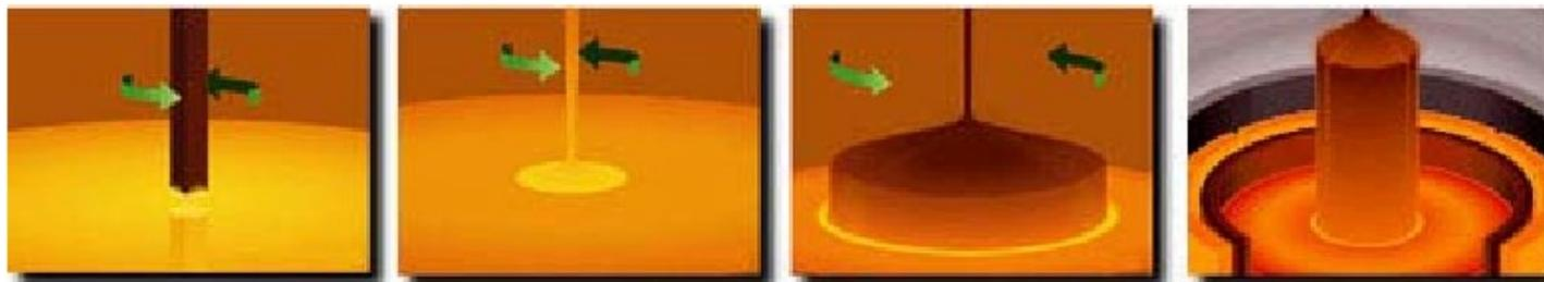
El silicio policristalino es molido e impurificado con elementos del tipo As, B, P o Sb y fundido a  $1400^{\circ}\text{C}$  en un crisol de cuarzo en atmósfera de gas inerte (Ar) de alta pureza.
