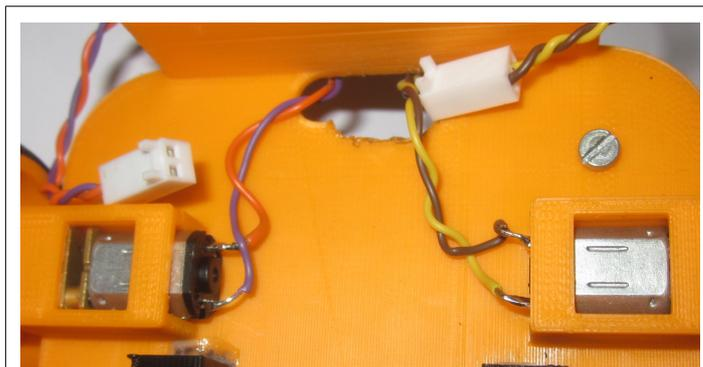
Conectores y conexión de los motores
